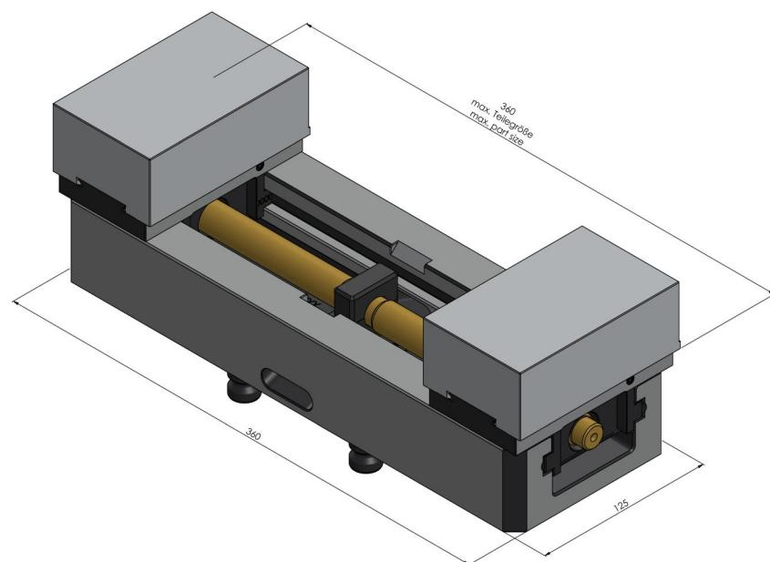
**Avanti 125, Morsa para fixação de perfil**
