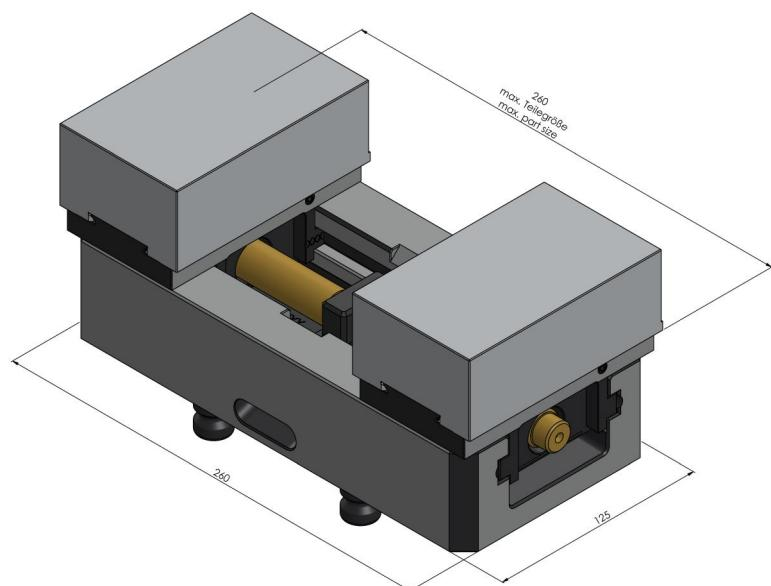
Avanti 125, Morsa para fixação de perfil
