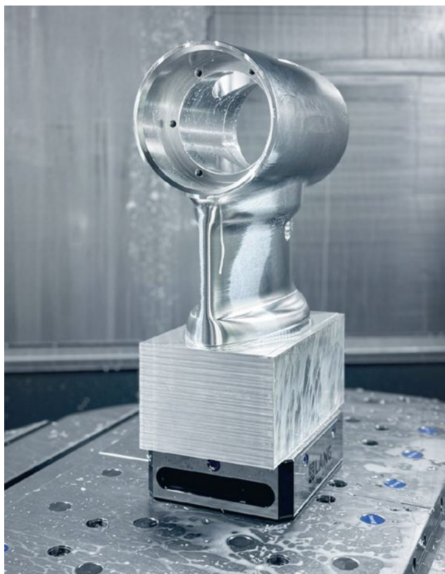
Serrage direct d'un boîtier d'engrenage par 4 pions de fixation avec plus de 80% d'enlèvement de matière.
