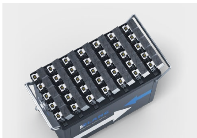
Chariot d'automatisation spéciale. Ici : 7 rangées de 5 positions pour 35 étaux avec une taille de pièce maximale de 70 × 100 × 120 mm.
