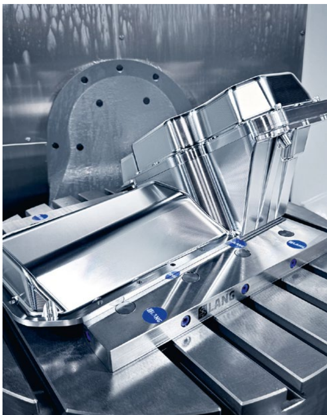
Carter d'huile issu du domaine du sport automobile, qui a été serré pour son usinage dans une plaque multiple par le biais de pions de fixation.
