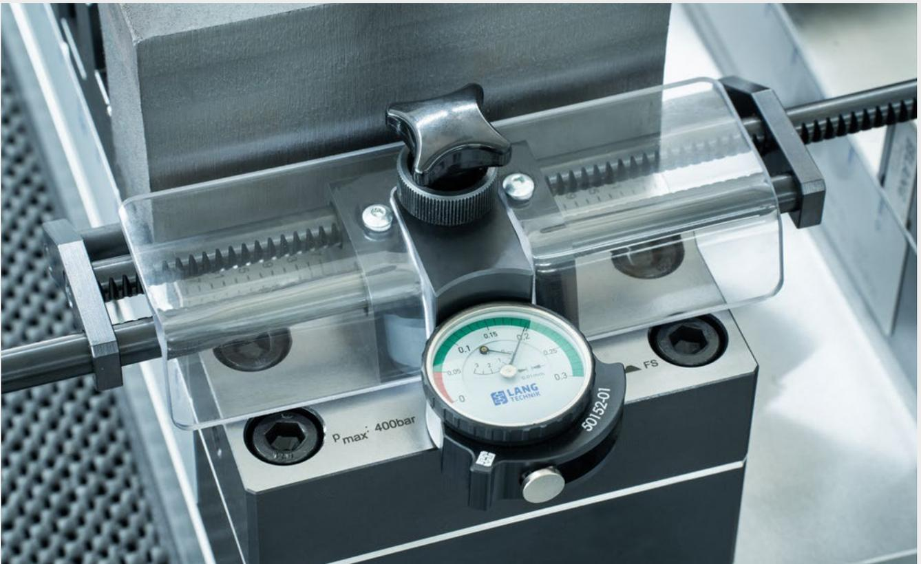
Über das Druckregelventil an der Prägestation wird der Prägedruck eingestellt. Die nachfolgende Tabelle gibt Aufschluss über die korrekte Prägetiefe bei unterschiedlichen Zugfestigkeiten. Diese ist für beide Varianten (Makro-Grip® und Makro-Grip® FS) allgemeingültig.
