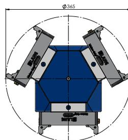
Im 3-Seiten-Spannturm können (bei horizontaler Spannung) alle Makro-Grip® 46 und 77 Schraubstücke gespannt werden.
