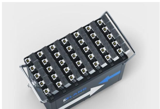
Automationswagen mit spezieller Konfiguration. Hier: 7 Reihen à 5 Positionen für 35 Schraubstöcke mit maximaler Teilegröße von 70 × 100 × 120 mm.
