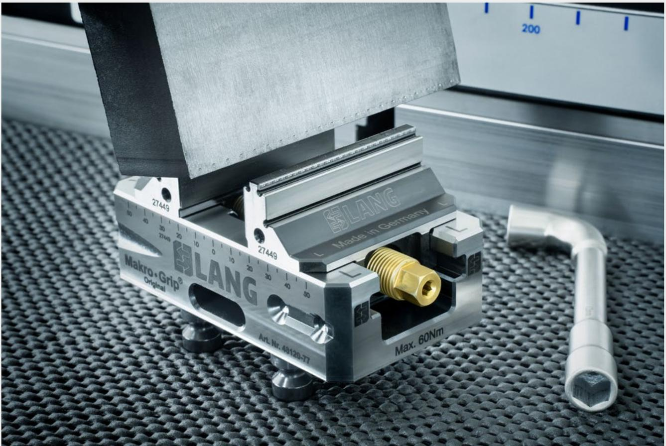
Der Formschluss entsteht durch Vorprägen des Werkstückrohteils. Hierbei wird dieses unter hohem Druck mit einer definierten Kontur versehen. Dieser Vorgang geschieht an einer Prägestation bereits vor dem eigentlichen Spannprozess. Im Spannprozess mit einem
