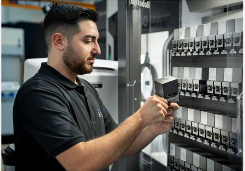
Noch platzsparender, noch mehr Schraubstöcke auf kleiner Fläche, noch kosteneffizienter. Das neue RoboTrex Compact Automationsystem vereint alle Vorzüge des großen Bruders, ist aber speziell für Anwendungen im Kleinbauteilbereich ausgelegt. Der integrierte Fanuc-Roboter transportiert Bauteile bis 7 kg Gewicht vom Speicher
