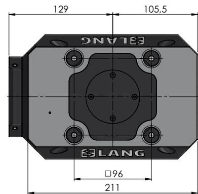
**AUTOMATION-NULLPUNKTSPANNSYSTEM 96, PNEUMATISCH**
