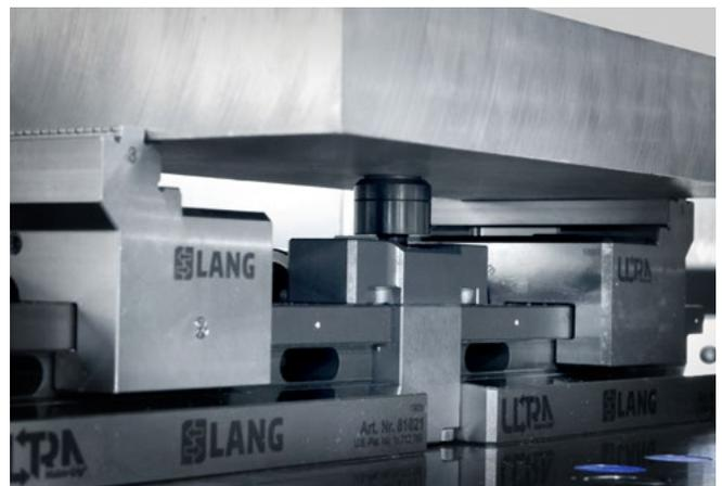
Über einen Innensechskant wird die Betätigungsstange bedient. Hiermit lässt sich die Auflagehöhe des mechanischen Unterstützers von minimal 28,5 mm bis maximal 42,5 mm einstellen.
