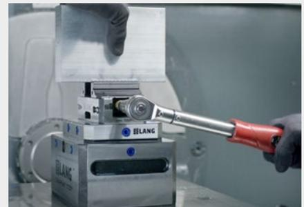
In wenigen Schritten kann durch Vorprägen eines Werkstückrohteils ein erheblicher Mehrwert für die Werkstückspannung erzielt werden. Der Prägevorgang dauert weniger als fünf Sekunden und benötigt keine zusätzlichen Maschinenkapazitäten. Die Prägung
