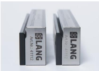
Links: Prägebacke mit ursprünglicher Dicke von 18 mm. Rechts: Nachgearbeitete Prägebacke mit einer Dicke von 15 mm.
