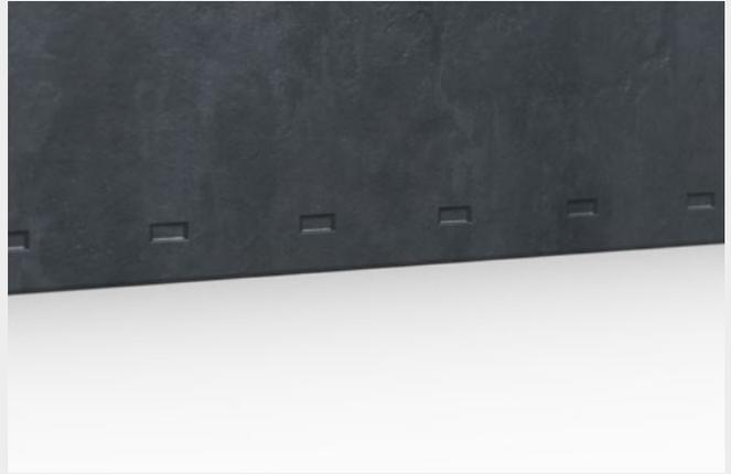
Die Prägekantur mit abwechselnden Prägezahnabdrücken und Tiefenanschlügen ist deutlich sichtbar. Die Tiefe der Tiefenanschlüge sollte hierbei etwa 0,05 mm betragen. Die Tiefe der Prägezahnabdrücke beträgt etwa 0,20 mm.
