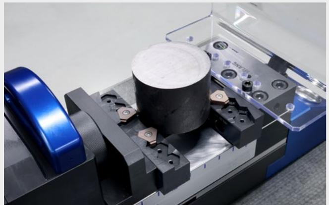
Die Prägetechnik ist sowohl für zylindrische als auch für quaderförmige Rohteile (zwei parallele Flächen) prädestiniert und bei allen nichtspröden Materialien anwendbar. Ausgeschlossen sind bspw. Graphit, Verbundfaserwerkstoffe wie Carbon, sowie teilweise Guss.
