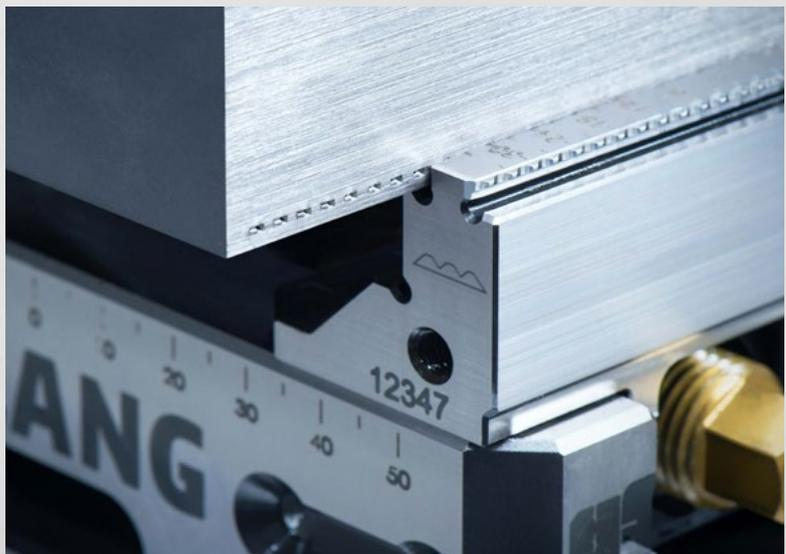
Mehr Performance und Spannleistung beim Fräsen! Die neue, durchgängige „Vollverzahnung“ punktet besonders bei weichen Materialien, zähen Werkstoffen und Bauteilen mit geringer Spannfläche. Nutzer profitieren von einer um bis zu 60 % höheren Haltekraft. Makro·Grip® FS ist als zusätzliche Spannbacken-Variante
