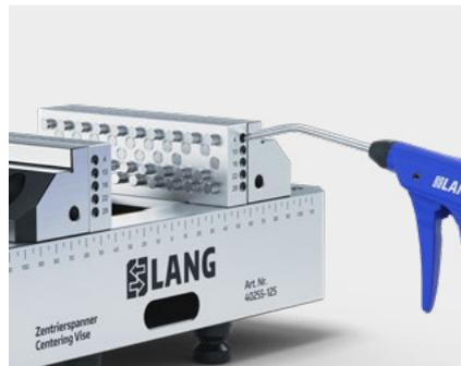
Per Druckluft lassen sich die Stifte Reihe für Reihe ausblasen. Da die Spannbacken vorne komplett geschlossen sind, können sich keine Spänenester bilden.
