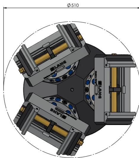
Bei vertikaler Spannung können in der 3-Seiten-Pyramide Makro-Grip® 5-Achs-Spanner mit maximaler Länge von 210 mm gespannt werden (links). Horizontal eingespannt ist eine maximale Schraubstocklänge von 260 mm möglich (rechts).
