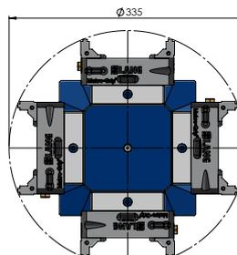
Im 4-Seiten-Spannturm können (bei horizontaler Spannung) Schraubstücke mit maximaler Grundkörperlänge 130 mm gespannt werden.
