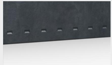
Bei Werkstoffen bis ca. 550 N/mm<sup>2</sup> Zugfestigkeit sollte der Abdruck des Tiefenanschlags über und unter der Prägekantur am Material sichtbar sein. Die Tiefe der Prägekantur beträgt dann etwa 0,3 mm. Dies gilt pauschal für alle Werkstückbreiten.
