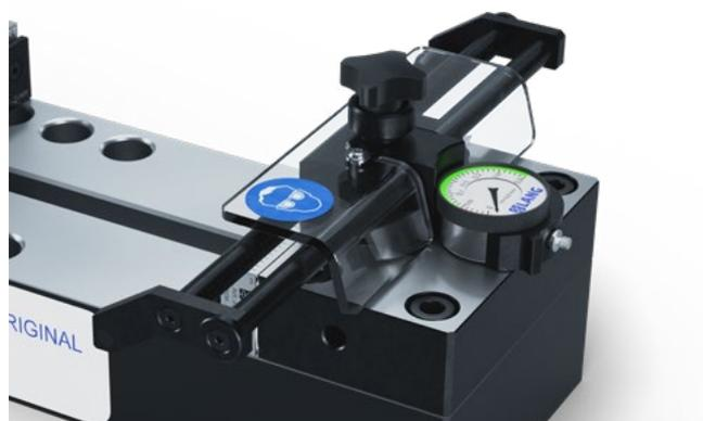
Montierte Zentriereinheit und Prägetiefen-Messvorrichtung auf bestehender Prägestation.
