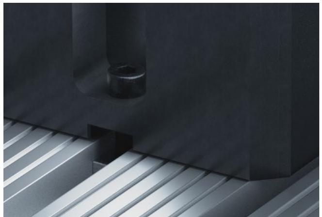
Falls der Unterbau permanent auf dem Maschinentisch verbleiben soll, bietet sich eine direkte Befestigung in den Nuten des Maschinentisches an. Eine Nullpunktplatte und deren Aufbauhöhe von 27 mm kann in diesem Fall eingespart werden.
