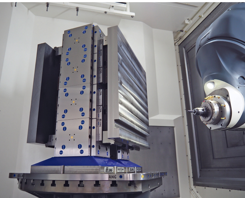
1 Großteile bis 855 Millimeter und mehr werden mit Makro Grip Ultra zuverlässig gespannt. Der Maschinenraum wird dabei optimal ausgenutzt © Hanser
